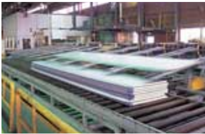
水発泡硬質ウレタンフォームとガルバリウム鋼板を一体成型した「トヨーガルダン」の製造
