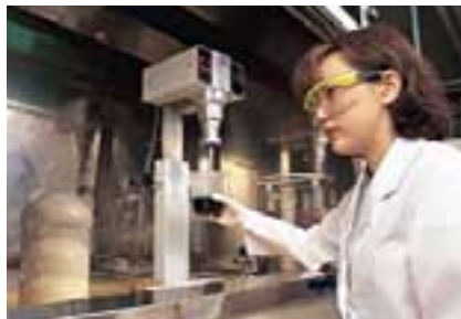
ウレタンフォームの水発泡実験(左)と水発泡ウレタンフォーム使用建材(下)
