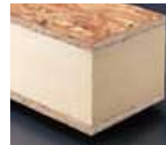
ウレタンフォームの水発泡実験(左)と水発泡ウレタンフォーム使用建材(下)
