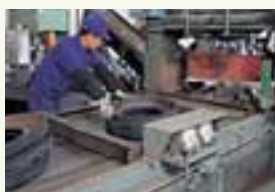
コジェネレーション用燃料のための廃タイヤの粉砕
